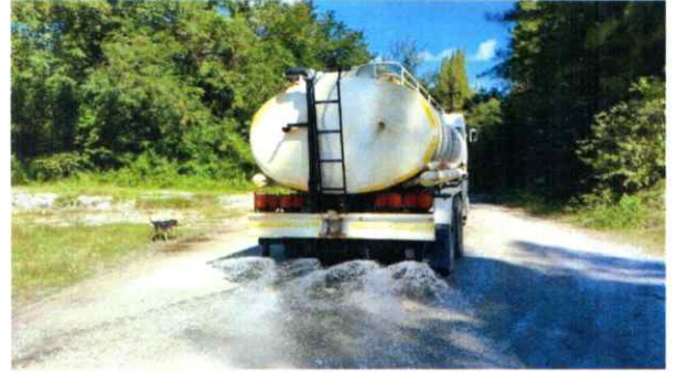
รูปที่ 2 รถบรรทุกน้ำดีพรมเส้นทาง
